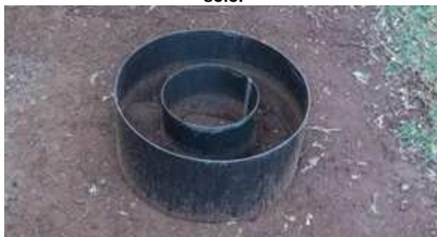
O teste termina quando a taxa de infiltração permanece constante. Na prática, considera-se que isto ocorra quando a taxa de infiltração varia menos que 10% dentro de 1 (uma) hora, chegando então, a chamada taxa de infiltração estável.
