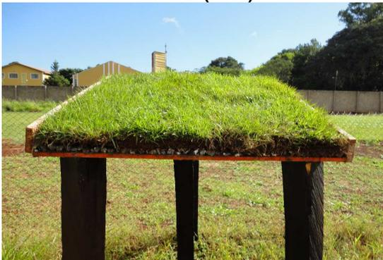
**Figura 5 – Camadas de percolação das águas das chuvas no protótipo**
