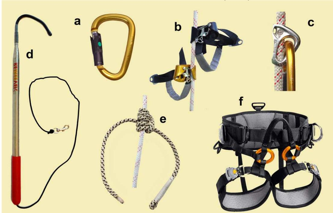
Quadro 1 – Equipamentos usados nos levantamentos de epífitos no IFFSC –FOD. \* Equipamento essencial e diferenciado para bom desempenho em arvorismo; Ω Equipamento essencial e diferenciado para bom desempenho e segurança em arvorismo; \* Equipamento importado dos Estados Unidos; Δ Adaptados até a chegada dos produtos importados; ° Equipamento confeccionado com material importado.
