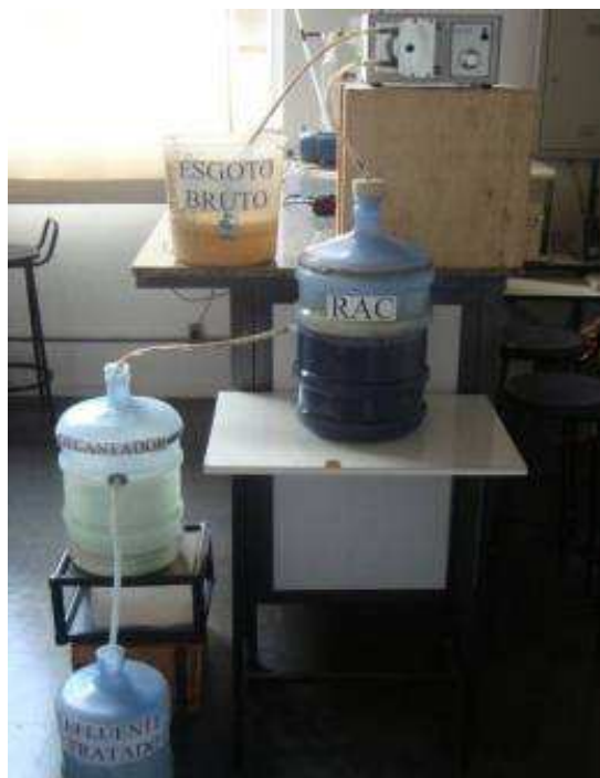
Figura 3 - Unidade de tratamento com decantador.
