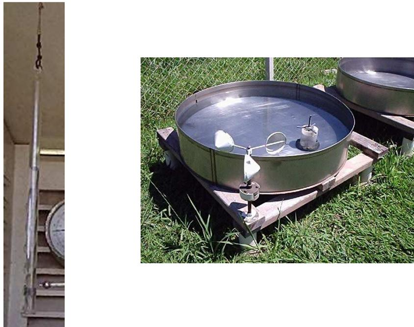
Figura 2 - Evaporímetro de Piche instalado no abrigo termométrico (esquerda) e o Tanque Classe A e seus componentes sobre o gramado da estação climatológica.
