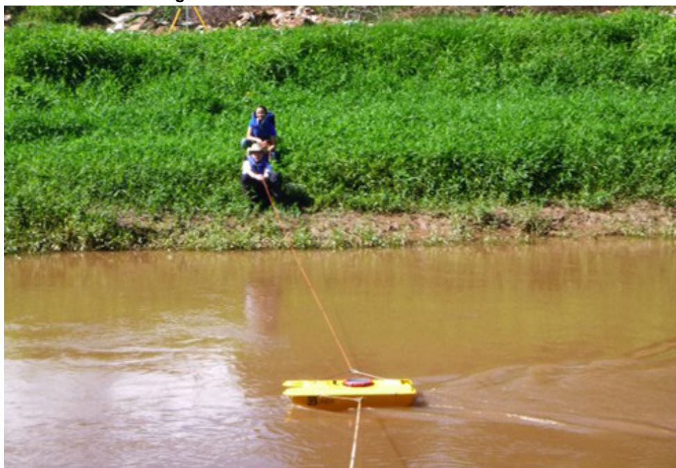
Figura 4 – Uso do medidor de vazão Qliner V3.
